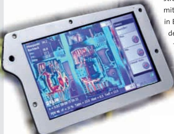
Temperatur sichtbar gemacht: Kameradisplay eines Infrarot-Messsystems
